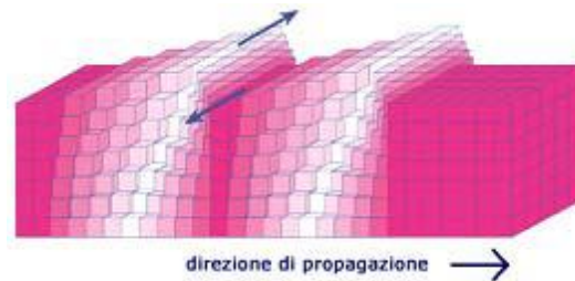
Figura 17: Propagazione dell'onda di superficie di Love.
